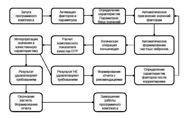
Рисунок 1 — Последовательность вычисления комплексного показателя качества
